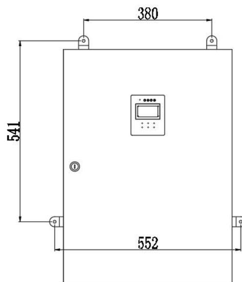
图 4 安装孔位图
