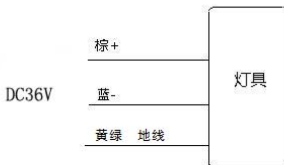
图 5 灯具接线示意图
