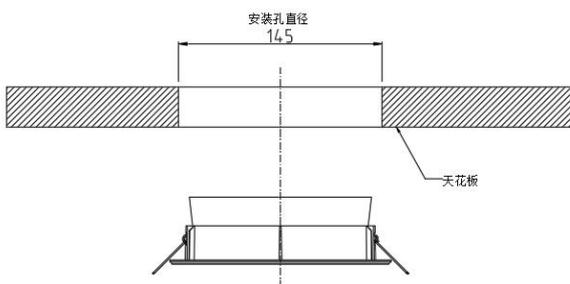
图 4 ZS08-Y5 安装示意图
