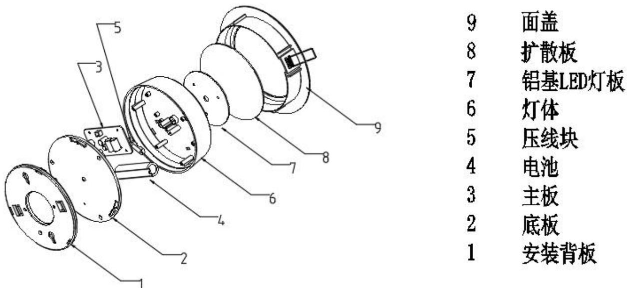
图 2 ZS08-Y5 系列产品结构示意图
